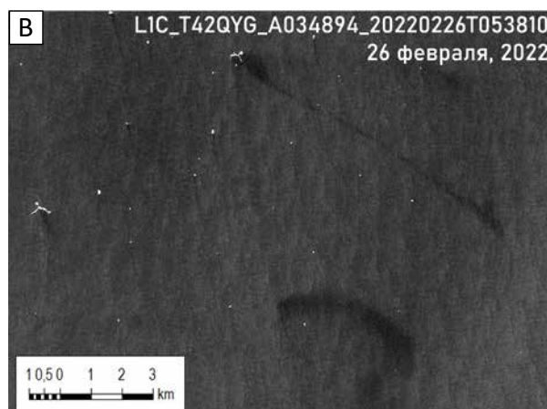
Рис. 3. Примеры нефтяных пятен на фрагментах снимков Sentinel-2: А — вызванные судами (светлое пятно — судно, темная черта — смесь отработанного топлива и турбулентного следа от движения судна), В — вызванные разливами с платформ и судов Fig. 3. Examples of oil seepages in Sentinel-2 imageries: А — caused by ships (light slick — ship, dark line — fuel waste mixture and turbulent trail from ship movements), В — caused by spills from platforms and ships
