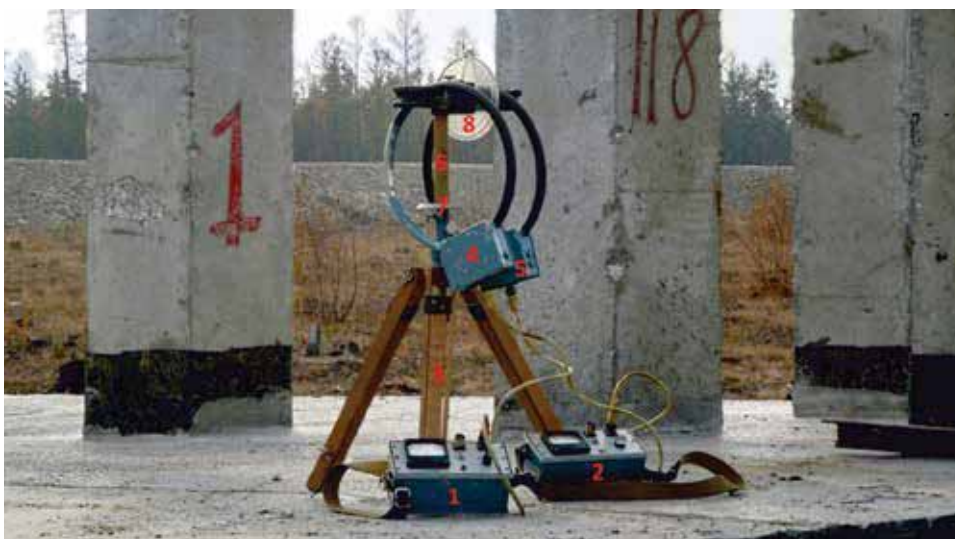
Рис. 2. Фотография аппаратуры СЭМЗ перед началом работы методом ДИЗ на одной из строительных площадок Якутии
