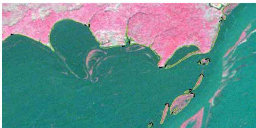
**Рис. 6.** Диапазон изменения положения линии уреза воды (затапливаемая зона прирусловой поймы)
