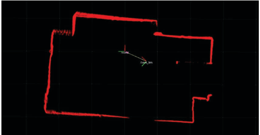
Рис. 6. Визуализация сообщений типа LaserScan Fig. 6. Visualization of LaserScan messages
