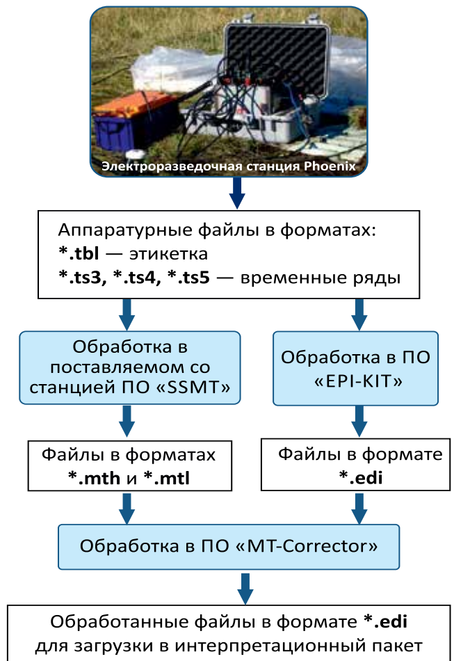
Рис. 1. Блок-схема формирования входных МТ данных Fig. 1. Block diagram of the formation of input magnetotelluric data
