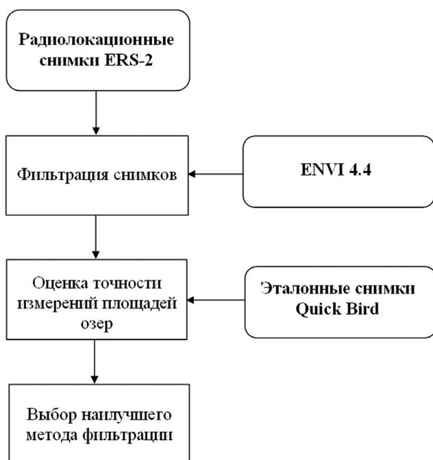
Рис. 2. Схема анализа влияния фильтрации радиолокационных снимков на точность измерения площадей озер
