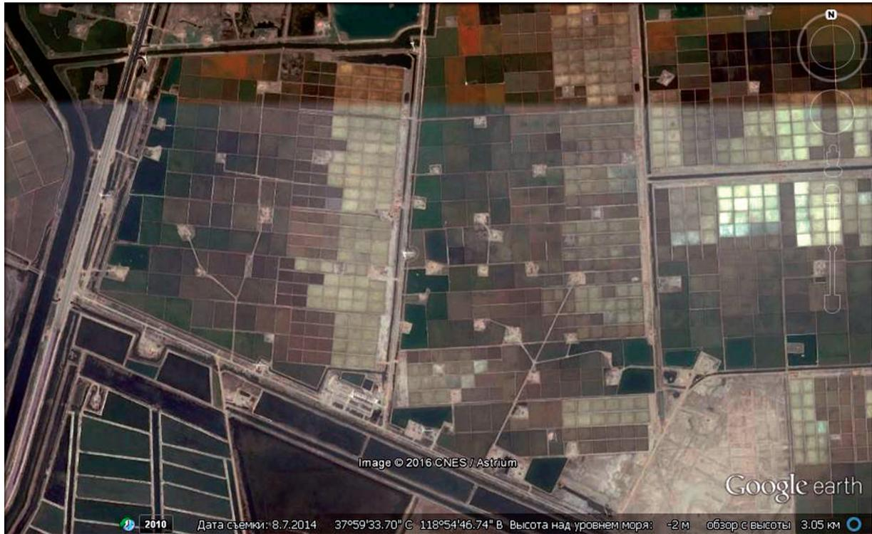
Рис. 9. Площадки скважин нефтедобычи, распространяющиеся на рисовые поля. Фрагмент снимка Google Earth
