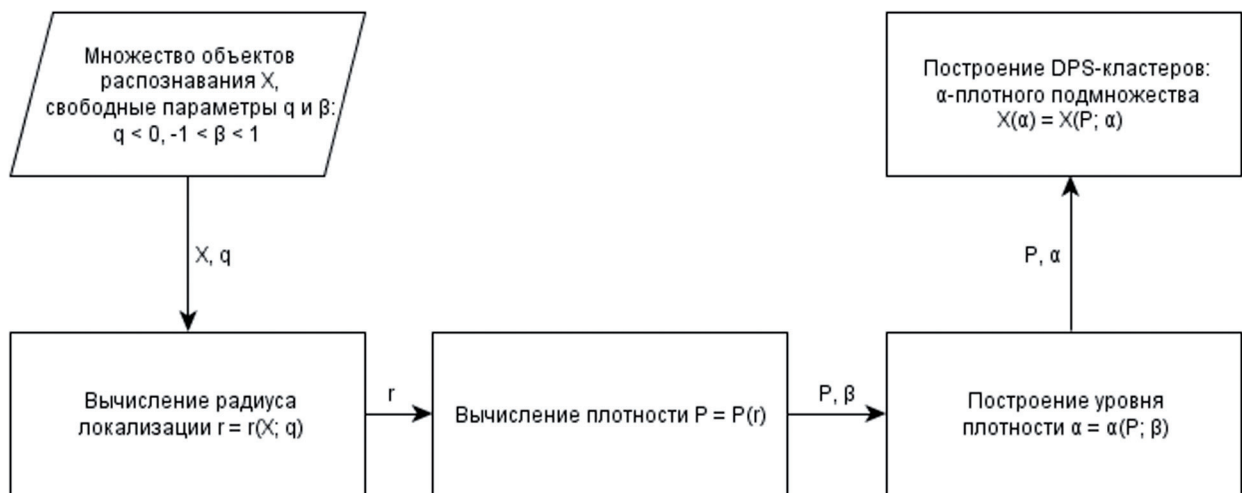
Рис. 2. Блок-схема этапов работы алгоритма кластеризации DPS (Discrete Perfect Sets). В параллелограмме – исходные данные, в прямоугольниках – этапы выполнения алгоритмом процедуры распознавания
