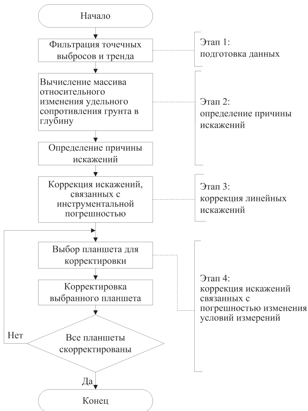
Рис. 6. Алгоритм формирования сводных карт распределения удельного сопротивления грунта
