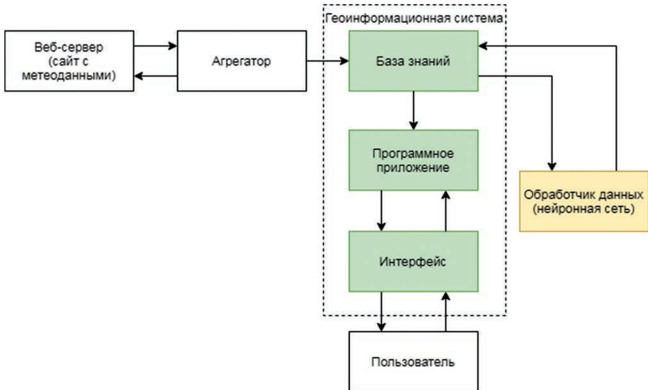
Рис. 2. Структурная схема ГИС поддержки принятия решения с использованием нейронных сетей
