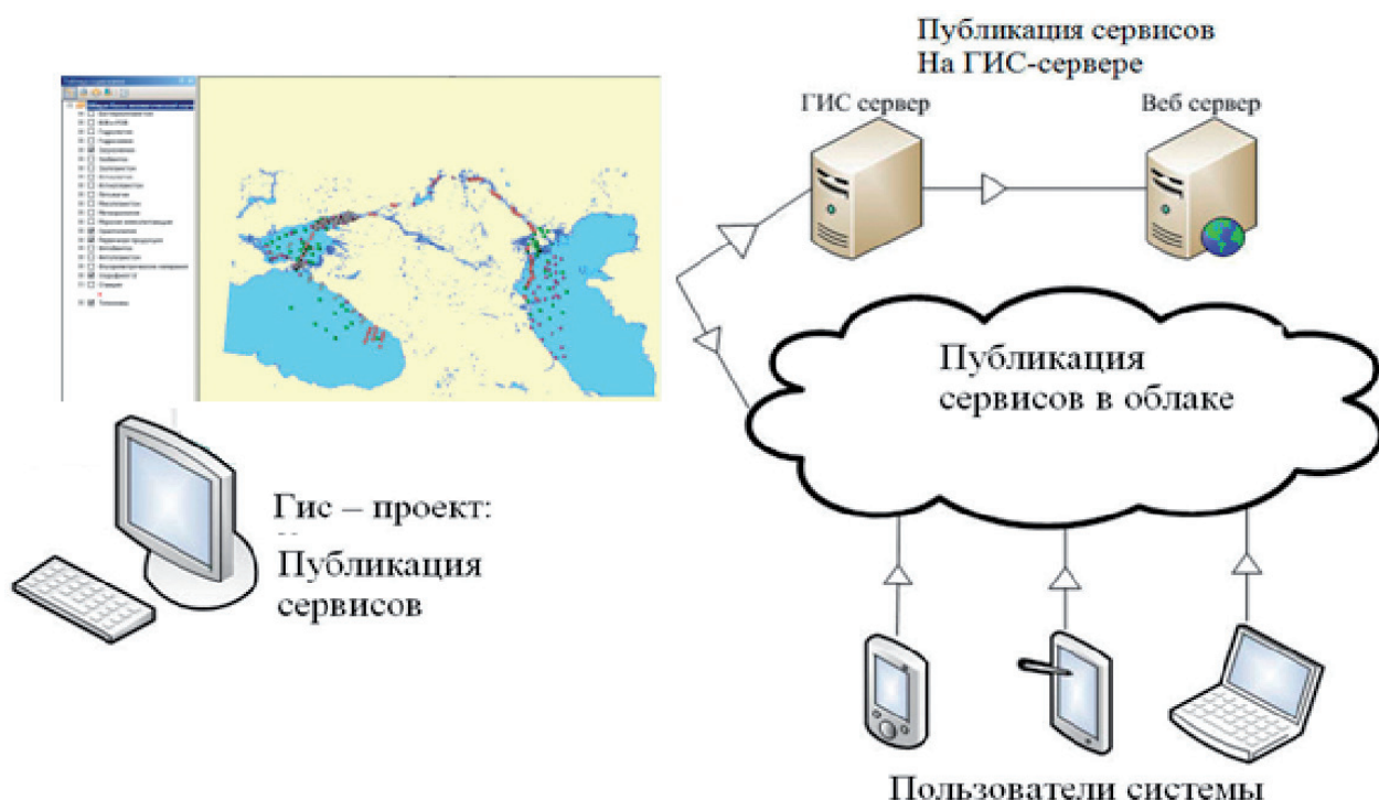
Рис. 4. Принципиальная схема взаимодействия ГИС проекта и геопортала на основе технологической платформы ArcGIS Online [4]
