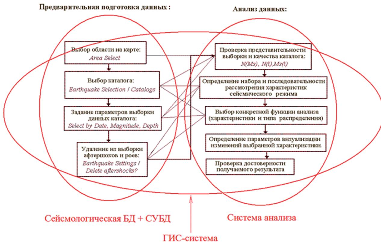
Рис. 1. Логико-функциональная структура и последовательность исследования сейсмичности в системе EEDB
