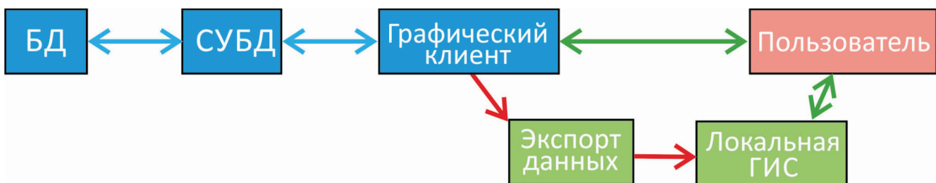
Рис. 1. Схема операционного взаимодействия в версии ИС, которая предшествовала описанной в данной статье. Стрелки: синие – автоматическое взаимодействие программных компонентов, красные – ручные преобразования, выполняемые оператором, зеленые – работа с ИС внешних пользователей
