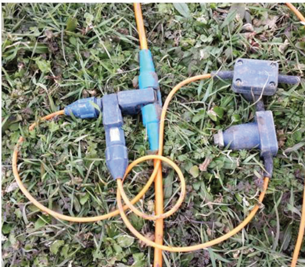
Рис. 4. Справа – схема установки и распайки датчиков спаренной регистрации ZY. Слева – соединение датчиков путем штатного приспособления «прищепка»
