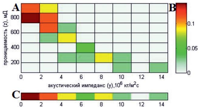
Рис. 2. А – карта плотности данных зависимости «акустический импеданс – проницаемость», В – легенда по параметру количества данных, попавших в ячейку, С – легенда по максимальным значениям по оси Y на выбранном интервале по оси X
