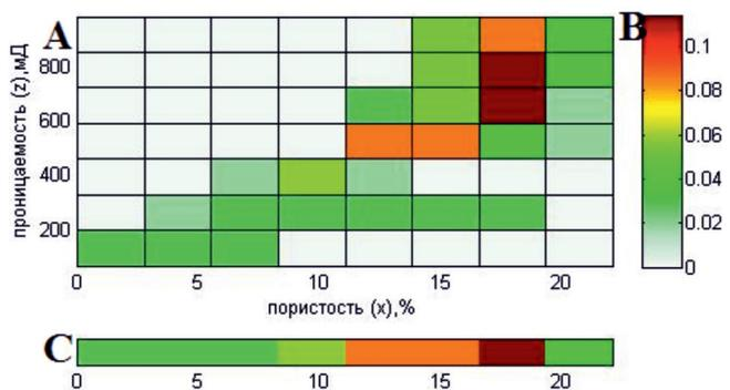
Рис. 3. А – карта плотности данных зависимости «пористость – проницаемость», В – легенда по параметру количества данных, попавших в ячейку, С – легенда по максимальным значениям по оси Y на выбранном интервале по оси X
