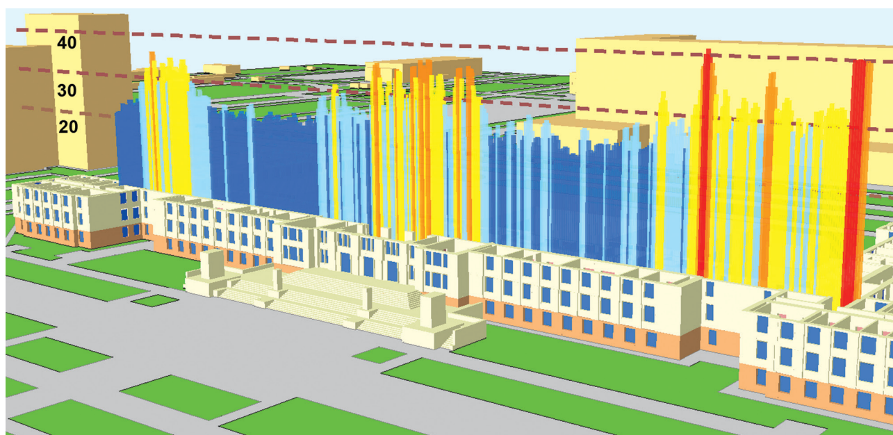
Рис. 3. Пример трехмерного отображения вариаций уровня радиосигнала (частота 104,7 МГц) внутри здания (пунктирными линиями показаны уровни, соответствующие значениям 20, 30 и 40 дБмВ; шаг цветовых градаций результатов измерений – 5 дБ)
