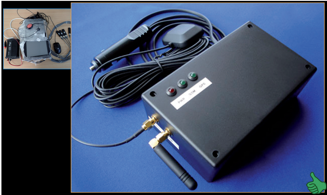
Рис. 6. Корпусное изделие АПК GSM мониторинга конца 2015 года на базе микроконтроллера STM32
