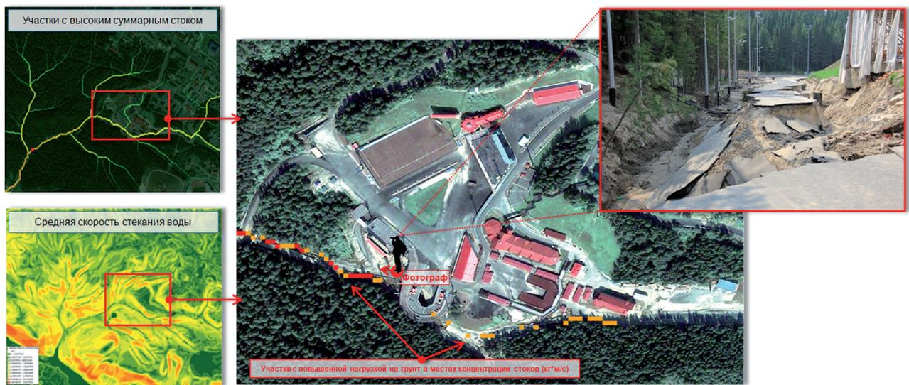
Рис. 9. Результат работы алгоритма, определяющего участки повышенной нагрузки на грунт в местах концентрации дождевых стоков воды (выделены красным и желтым цветом)
