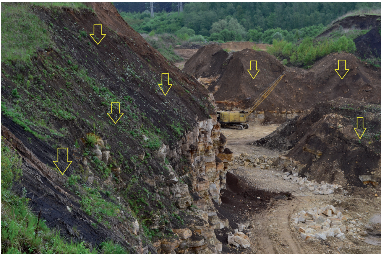
Рис. 1. Отвалы карьера по добыче известняка и вскрышной уступ (помечены стрелками)
