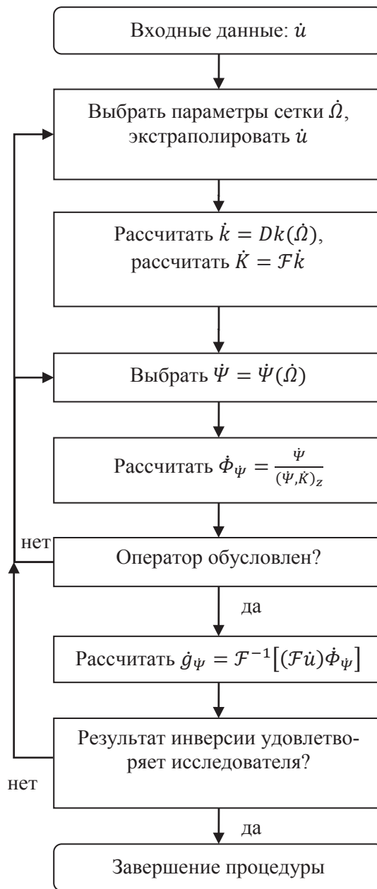
Рис. 5. Общая схема предлагаемого метода инверсии данных гравиметрии
